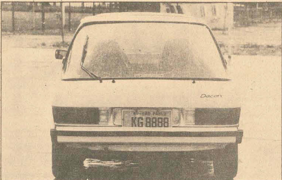
No panorâmico vidro traseiro, o detalhe do limpador e dos esguichos de água.
