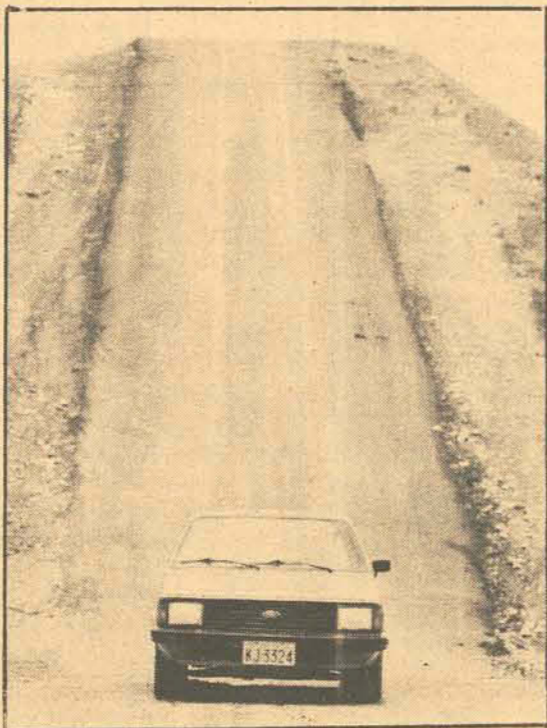
Na rampa com inclinação de 30 por cento, o teste da eficiência dos sistemas de freios e de embreagem.
