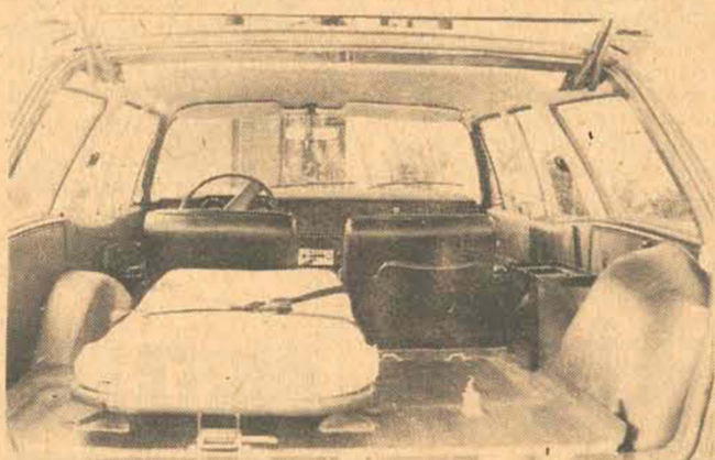
O carro vem equipado com maca, caixa de medicamentos e acessórios de sinalização, além de um extintor de grande capacidade.
