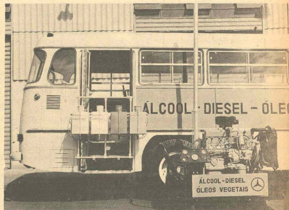
Motores diesel Mercedes-Benz funcionam com vários tipos de combustível, entre os quais o álcool, após ligeiras modificações na bomba injetora.
