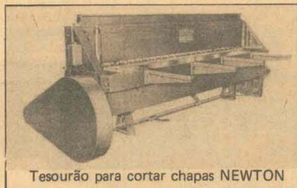
Tesourão para cortar chapas NEWTON
