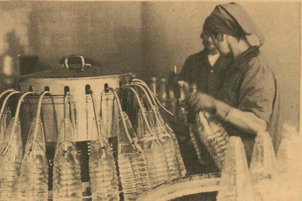
As garrafas de plástico rígido, também são envasadas mecanicamente. Só as defeituosas são retiradas por operários.
