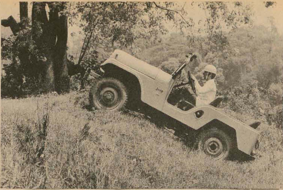
Com 91 cv e 2.300 cm3 de cilindrada, o novo jipe é capaz de alcançar os 100 km/h e escalar rampas de até 44% de inclinação.
