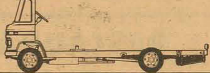
Chassi com meia cabina, para servir de base a micro-ônibus ou furgão integral. Distâncias entre-eixos de 2,95m, 3,50m e 4,10m.
