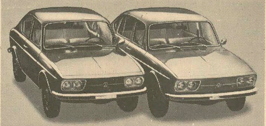
O 1300 e o Fusão têm agora novo sistema de ventilação, antiembacante. Tomada de ar na frente do pára-brisa.
