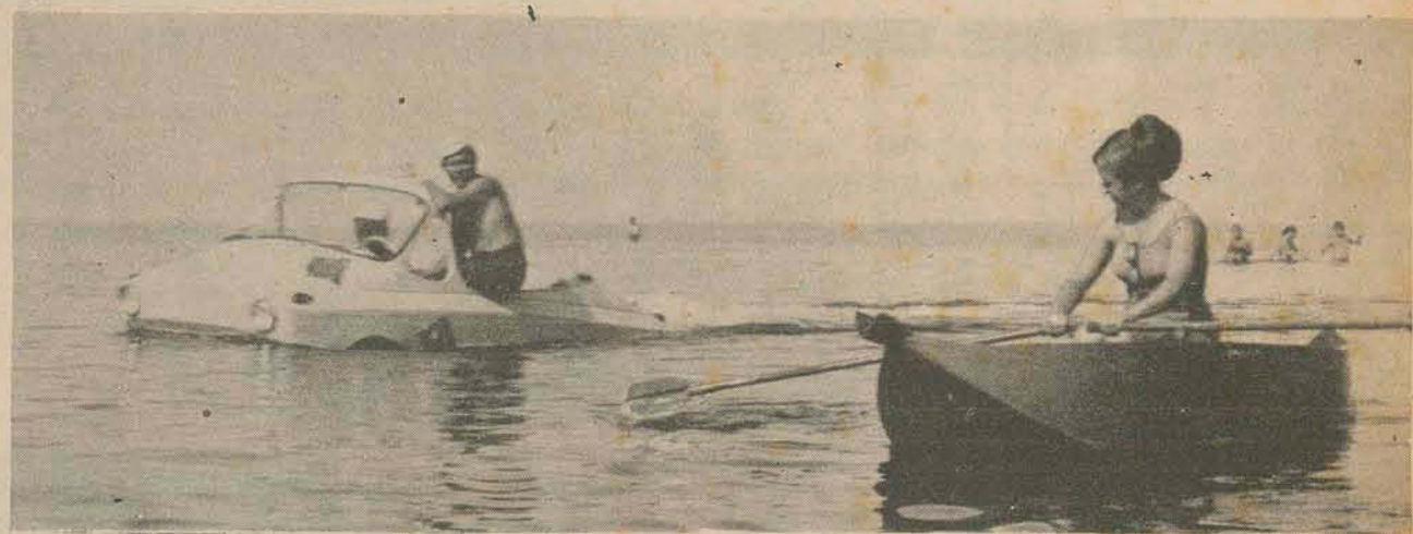
Carro anfíbio, com carroceria de fibra de vidro, num lago perto de Moscou.
