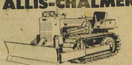
Especialmente fabricados para a construção de açudes, taipas, barragens e para preparo do solo e irrigação.
