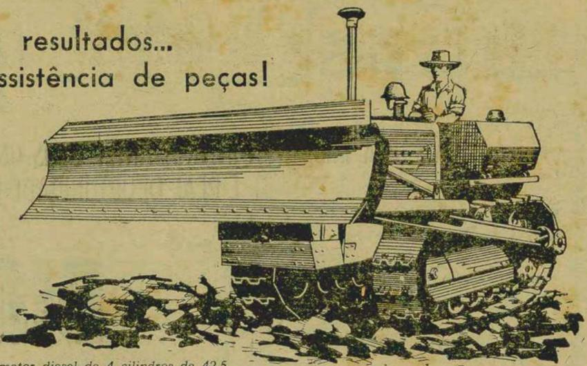
Fabricado por uma das mais modernas fábricas de tratores do mundo, o trator de esteira MAZUR, moderno e robusto, produz eficiente trabalho em qualquer espécie de terreno, seja úmido, mole ou arenoso, graças à pequena pressão específica sobre o solo.
