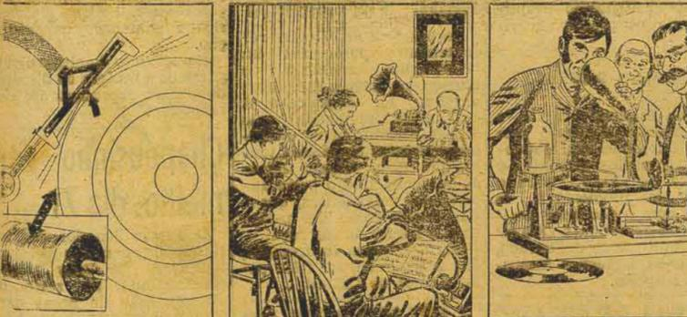
**2.a PRINCÍPIO** — Os primeiros fonógrafos dependiam da vibração e da movimentação de ondas sonoras num diafragma, a que estava presa uma agulha. A agulha riscava um padrão diminuto na folha de estanho que cobria um cilindro rotativo. Para repetir-se o som assim gravado, os traços feitos na folha de estanho movimentavam a agulha que fazia vibrar o diafragma, criando deste modo as ondas sonoras.
