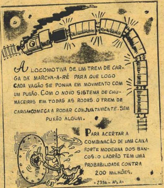
A LOCOMOTIVA DE UM TREM DE CARGA DA MARCHA-A-RÉ PARA QUE LOGO CADA VAGÃO SE PONHA EM MOVIMENTO COM UM PUXÃO. COM O NOVO SISTEMA DE CHUMACEIRAS EM TODAS AS RODAS. O TREM DE CARGA COMEÇA A RODAR CONJUNTAMENTE SEM PUXÃO ALGUM.
