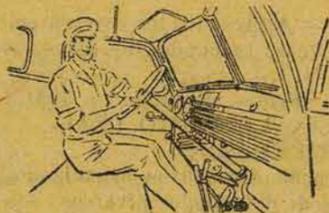
**Conforto** — coxins de borracha isolam a cabine de choque e vibrações. Ventilação e visibilidade perfeitas.
