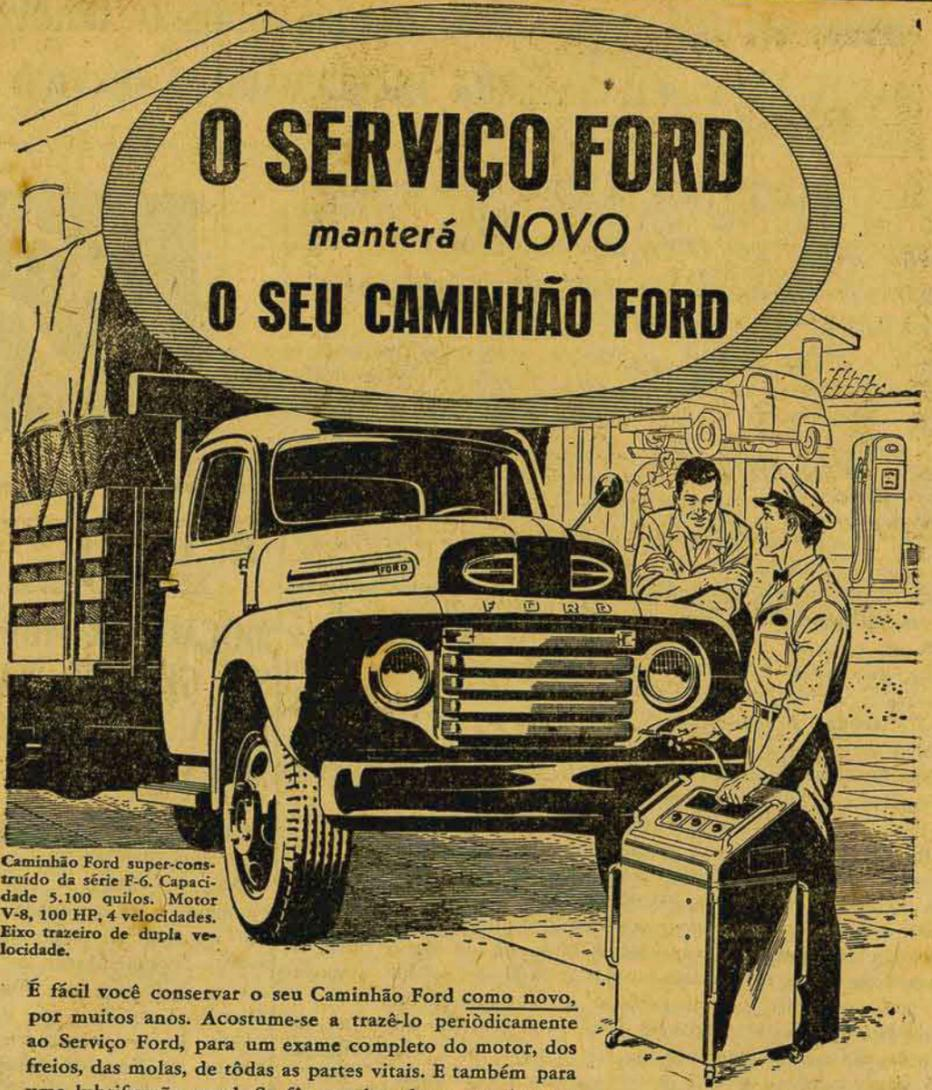
Caminhão Ford super-construído da série F-6. Capacidade 5.100 quilos. Motor V-8, 100 HP, 4 velocidades. Eixo trazeiro de dupla velocidade.
