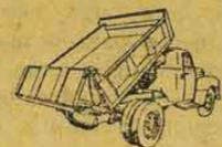
Carroceria basculante hidráulica, para 2,5 metros cúbicos sobre chassis F-5 ou F-6, de 134".
