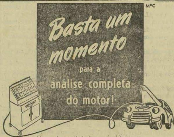
Um equipamento indispensável às garagens e oficinas! Os verificadores ALLEN para motores têm dispositivos para examinar Condensadores, Bobinas e Ângulos de Folga e para medir Voltagem, Amperagem, Vácuo, Alta Tensão e Compressão, além do Tacômetro Elétrico. Apenas duas extensões, destacáveis, bastam para 95% de todos os testes. Em poucas horas qualquer pessoa aprende a manejar perfeitamente o aparelho!
