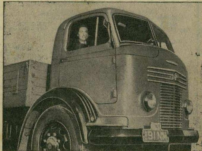
O novo caminhão "Cosmmer" (tipos de 5 e de 7 toneladas), pela sua força e pelo desenho frontal. O motor desenvolve 109 Bhp., sendo montado sob a cabine, a qual oferece lugar para dois passageiros, além do motorista, com temperatura controlável. O novo "Cosmmer" é o resultado de inúmeras pesquisas e estudos, tendo sido planejado para uso no ultramar, bem como para a própria Inglaterra. (British News Service).
