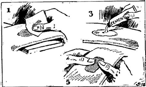
3 — Aplique uma leve camada de cimento sobre a câmara e o remendo, deixando-a secar durante alguns minutos e depois ponha uma segunda camada de cimento.
