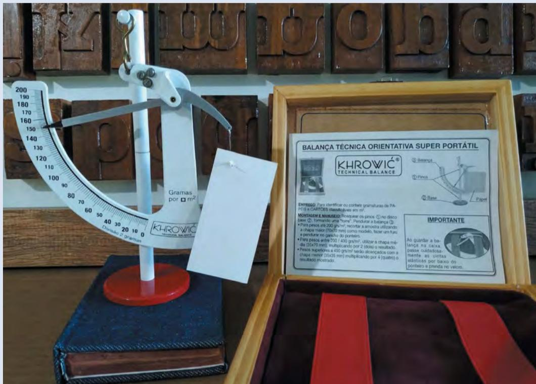
A coleção de Carlos revela ainda peças bastante curiosas, como o medidor para temperatura do chumbo (usado na fabricação de tipos) e uma balança técnica usada para medir a gramatura do papel. Objetos que ele foi guardando ao longo dos anos, na medida em que as peças ficavam
