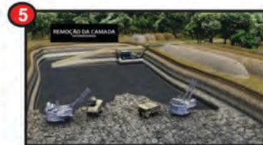
Em seguida, a camada intermediária é perfurada e detonada e o material é removido. O processo de extração se repete
