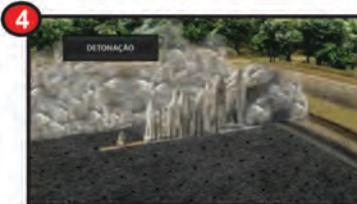
O xisto da camada superior é então detonado e enviado para um britador na própria mina e transferido para uma unidade de minério
