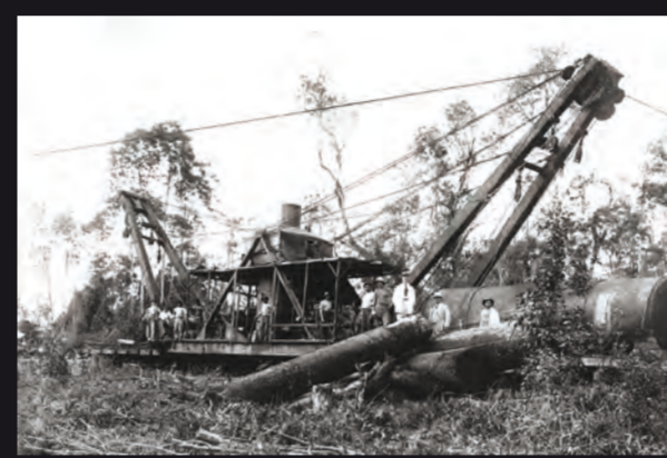
Poderosos guinchos da Lumber (1914) colhendo toras de pinheiro e imbuia até uma distância de 500 metros de cada lado de sua estrada de ferro, que chegou a ter 50 quilômetros distante de sua serraria de Três Barras
