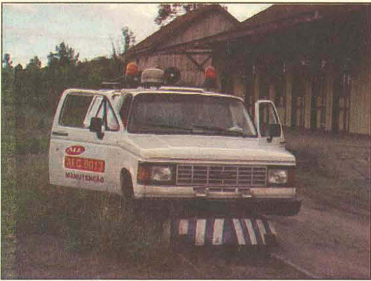
Auto de linha utilizado para transporte de trabalhadores e equipamentos durante a restauração
