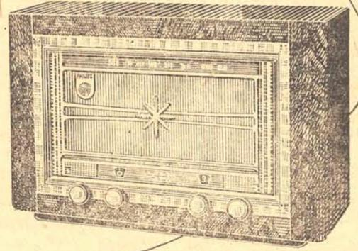
Mod. BR 639-A - 7 válvulas "Noval", ôhio magico, estágio de rádio-frequência, 6 faixas de ondas ampliadas, alto-falante Super M de 8" com tomada suplementar, 2 controles de tonalidade independentes, tomada e chave de "pick-up", funcionamento em 90 até 220 volts AC, mostrador com ponteiros, luxuosa caixa de madeira. Dimensões: 60x39x23 cm.
