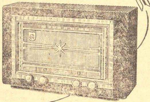
Mod. BR 639-A - 7 válvulas "Noval", ôlho mágico, estágio de rádio-frequência, 6 faixas de ondas ampliadas, a-to-fa-ante Super M de 8" com tom da suplementar, 2 controles de tonalidade independentes, tomada e chave de "pick-up", funcionamento em 90 até 220 volts AC, mostrador com ponteiros, luxuosa caixa de madeira. Dimensões: 60x39x23 cm.
