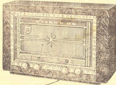
Mod. BR 639-A - 7 válvulas "Noval", olho magico, estágio de rádio-freqüência, 6 faixas de ondas ampliadas, alto-falante Super M de 8" com tomada suplementar, 2 controles de tonalidade independentes, tomada e chave de "pick-up", funcionamento em 90 até 220 volts AC, mostrador com ponteiros, luxuosa caixa de madeira. Dimensões: 60x39x23 cm.
