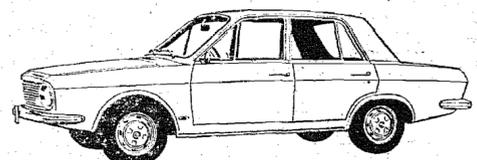
Velha visitar-nos. O Ford Corcel tem tração dianteira, radiador selado, cinco mancais, resistência, conforto para 5 pessoas, freio a disco, suspensão superdimensionada, motor dianteiro de 68 HP a 5.200 rpm (SAE), amplo porta-malas e economia — faz até 12 km com um litro de gasolina e só exige troca de óleo após cada 5.000 km rodados.
