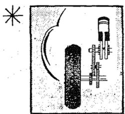
TRAÇÃO DIRETA do motor, sem peças de fricção intermediária (corrente ou cardan) que dão a "Vespa" uma VANTAGEM de 1,75 HP
