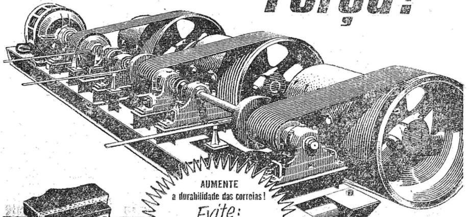
AUMENTE a durabilidade das correias! Evite: • tensões impróprias • polias com diâmetros inadequados • tipo de correia • polias de coroa muito alta • uso de ferramentas para ajuste das correias • contacto com óleo E ainda: limpe-as periodicamente.
