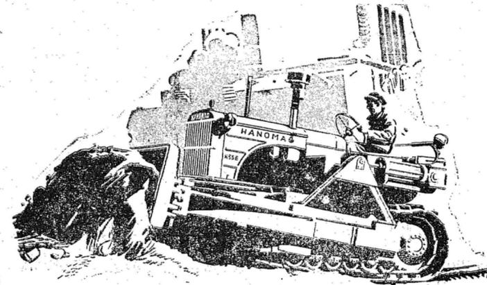
PRÓPRIO PARA ABERTURAS DE ESTRADAS. SEU USO COMBINADO COM O GUINCHO TORNA-SE IDEAL PARA AS SERRARIAS. EQUIPADO COM LAMINA "A N G L E D O Z E R" ENGATE TRAZEIRO E BARRA DE TIRO.
