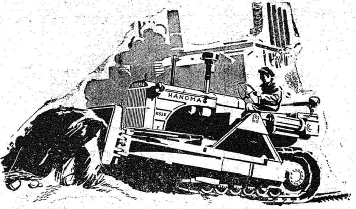
PRÓPRIO PARA ABERTURAS DE ESTRADAS. SEU USO COMBINADO COM O GUINCHO TORNA-O IDEAL PARA AS SERRARIAS. EQUIPADO COM LAMINA "A N G L E D O Z E R" ENGATE TRAZEIRO E BARRA DE TIRO.
