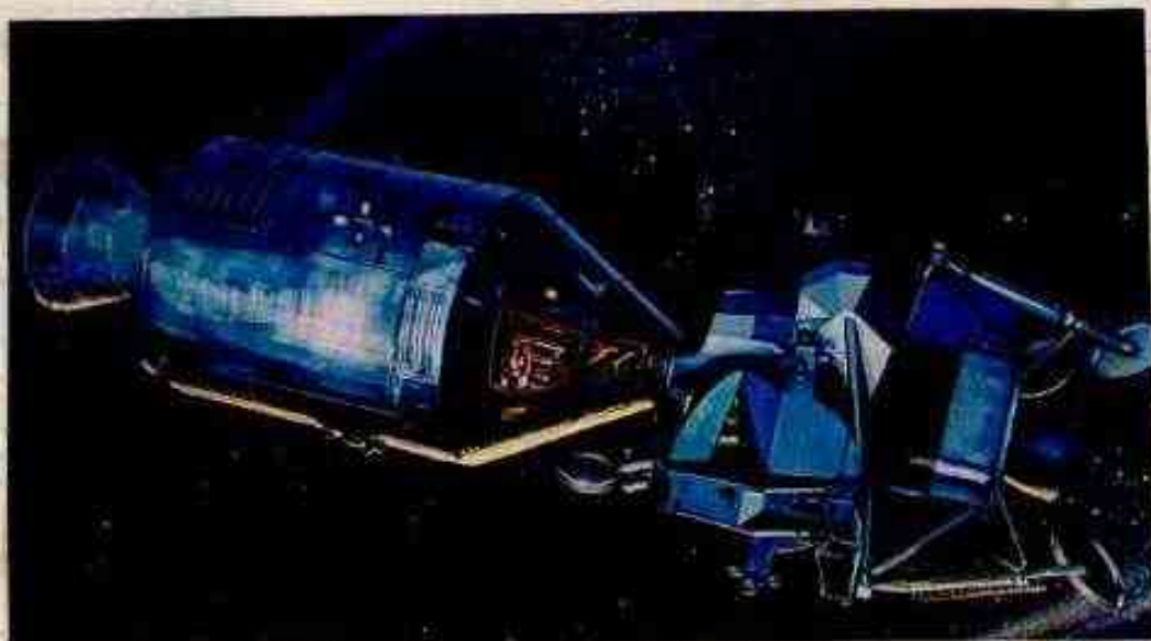
Há um caminho interno e outro externo entre a cabina Apolo e a módulo lunar. No 1.º deslocamento, McDivitt e Schweickart seguirão de rastros por um túnel. Mas Schweickart retornará pelo espaço, levando na mão uma câmara portátil de tevê.
