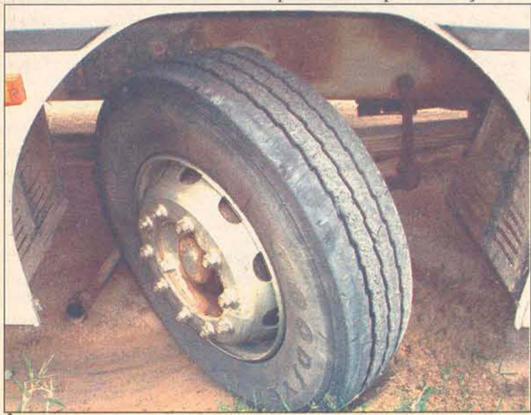
Ônibus teve o eixo das rodas quebrado por causa dos buracos na rua
