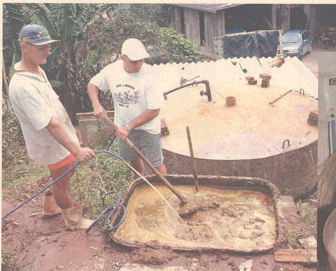
Depois de ser diluído em água, esterco vai direto para o biodigestor
