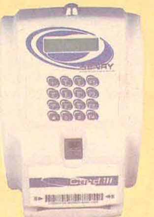
CARD III - Relógio Ponto Informatizado com alta capacidade de memória. Identificação através de impressão digital. Controla acesso em até 100 horários. Também possui opção de envio de mensagens específicas.
