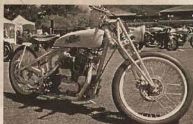
No final dos anos 1910 e começo dos anos 1920, as empresas iniciaram a tentativa de produzir motos de corrida. A 1915 Cyclone Board Track Racer usava o primeiro motor que tinha câmaras de combustão hemisféricas. O resultado foi um motor de 45 cavalos de potência, V-Twin. Estas foram produzidas por 2 anos, e somente 12 são conhecidas existentes atualmente.
