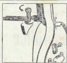
Duplo sistema anti-roubo: trava no câmbio (imobiliza o carro na marcha a ré); e nova trava interna nas portas dianteiras: para abrir é preciso comprimir e girar 1/2 volta o botão de trava (não pode ser violado!)
