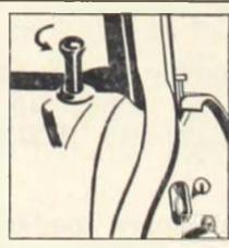
**NOVIDADE:** O duplo sistema anti-roubo! Trava no câmbio: o giro da chave aciona uma trava que imobiliza a alavanca do câmbio na posição marcha-à-ré. Trava interna das portas dianteiras: o botão de trava tem de ser girado (1/2 volta) para destravar a porta.
