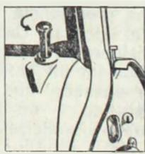
**NOVIDADE:** O duplo sistema anti-roubo! Trava no câmbio: o giro da chave aciona uma trava que imobiliza a alavanca do câmbio na posição marcha-à-ré. Trava interna das portas dianteiras: o botão de trava tem de ser girado (1/2 volta) para destravar a porta.
