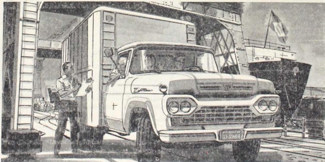
**SUPER FORD F-350** — Único caminhão de tonelage média fabricado no Brasil, para o transporte de mercadorias relativamente leves, mas volumosas. Capacidade de carga: 2.670 kg. Motor: V-8, de 167 H.P. Distância entre eixos: 3,30 m. Diferencial: reforçado, tipo hipóide.
