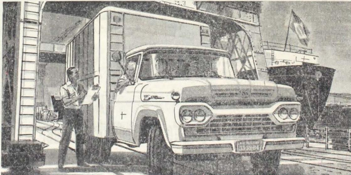
**SUPER FORD F-350** — Único caminhão de tonagem média fabricado no Brasil, para o transporte de mercadorias relativamente leves, mas volumosas. Capacidade de carga: 2.670 kg. Motor: V-8, de 167 H.P. Distância entre eixos: 3,30 m. Diferencial: reforçado, tipo hipóide.
