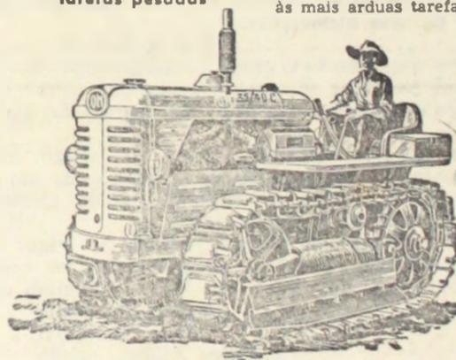
com 6 marchas a frente e 2 a ré. Sapatas de 40 cms. Motor de 37 H.P. Construção ultra-forte para resistir às mais arduas tarefas.
