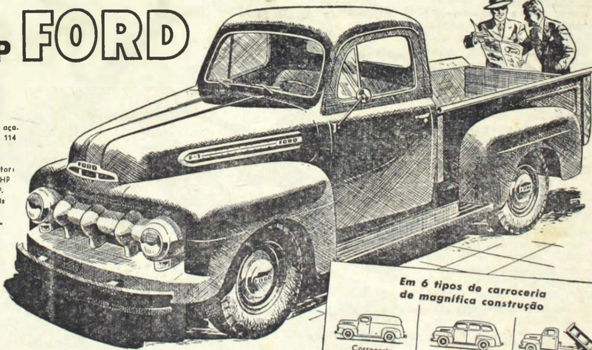
Carroceria de aço. Chassis F-1 de 114 polegadas. Capacidade: 850 quilos. Motor: 6 cilindros 95 HP ou V-8 100 HP. Também chassis F-2 e F-3 de 122 polegadas.
