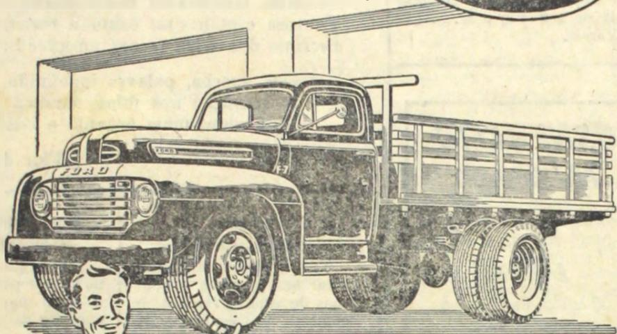
Caminhão Super-Construído Ford. Peso máximo total: 8.675 quilos. Transmissão de 5 velocidades para a frente. Motor V-8, de 145 cavalos!
