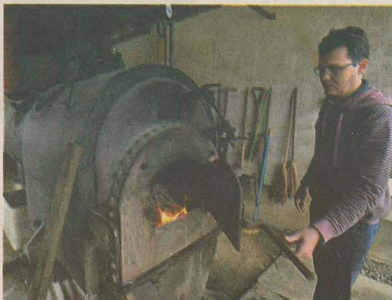
**CALDEIRA** Sistema de aquecimento de água para derreter a parafina é centralizado em uma locomotiva alemã de 1925
