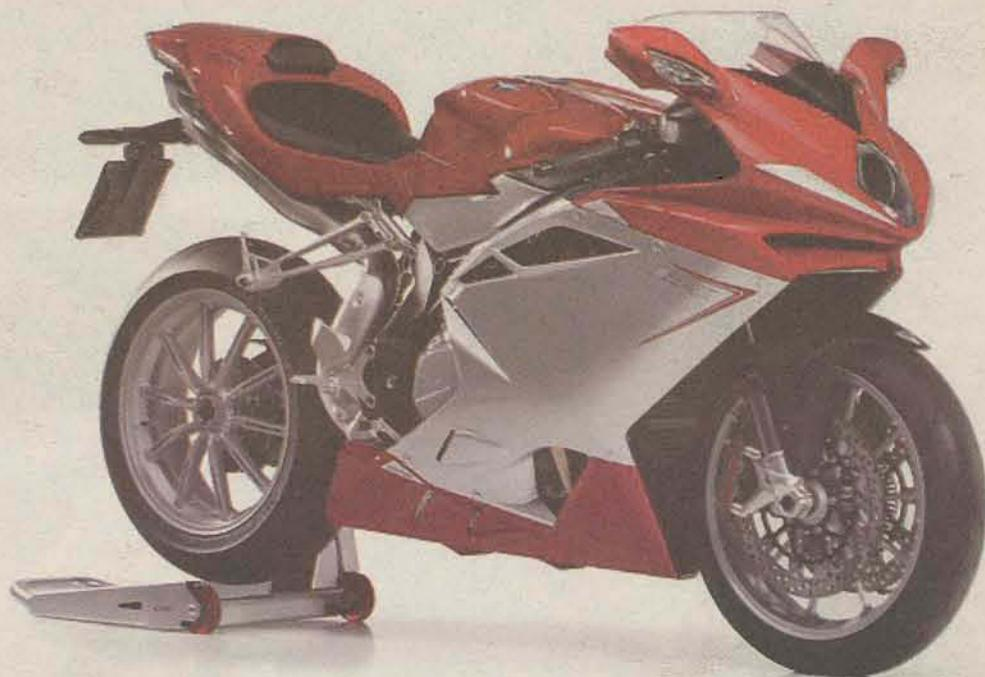
plo comando no cabeçote (DOHC). Porém, teve sua taxa de compressão aumentada para 13:1 e o diâmetro x curso passa a ser 79 x 50,9 mm no lugar dos 76 x 55 de outrora. Os ajustes aumentaram a potência para 195 cv a 13.400 rpm, e o torque agora é 11,3 kgf.m a 9.500 rpm. O sistema de distribuição também foi aprimorado. As válvulas de admissão e escape agora utilizam uma única mola ao invés de duas. Isso reduz a massa do conjunto e permite que o mesmo acompanhe o motor em faixas maiores de giro.
