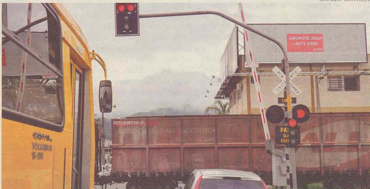
NÃO FUNCIONOU Cancela manteve o braço erguido na passagem do trem, ontem, na Procópio
