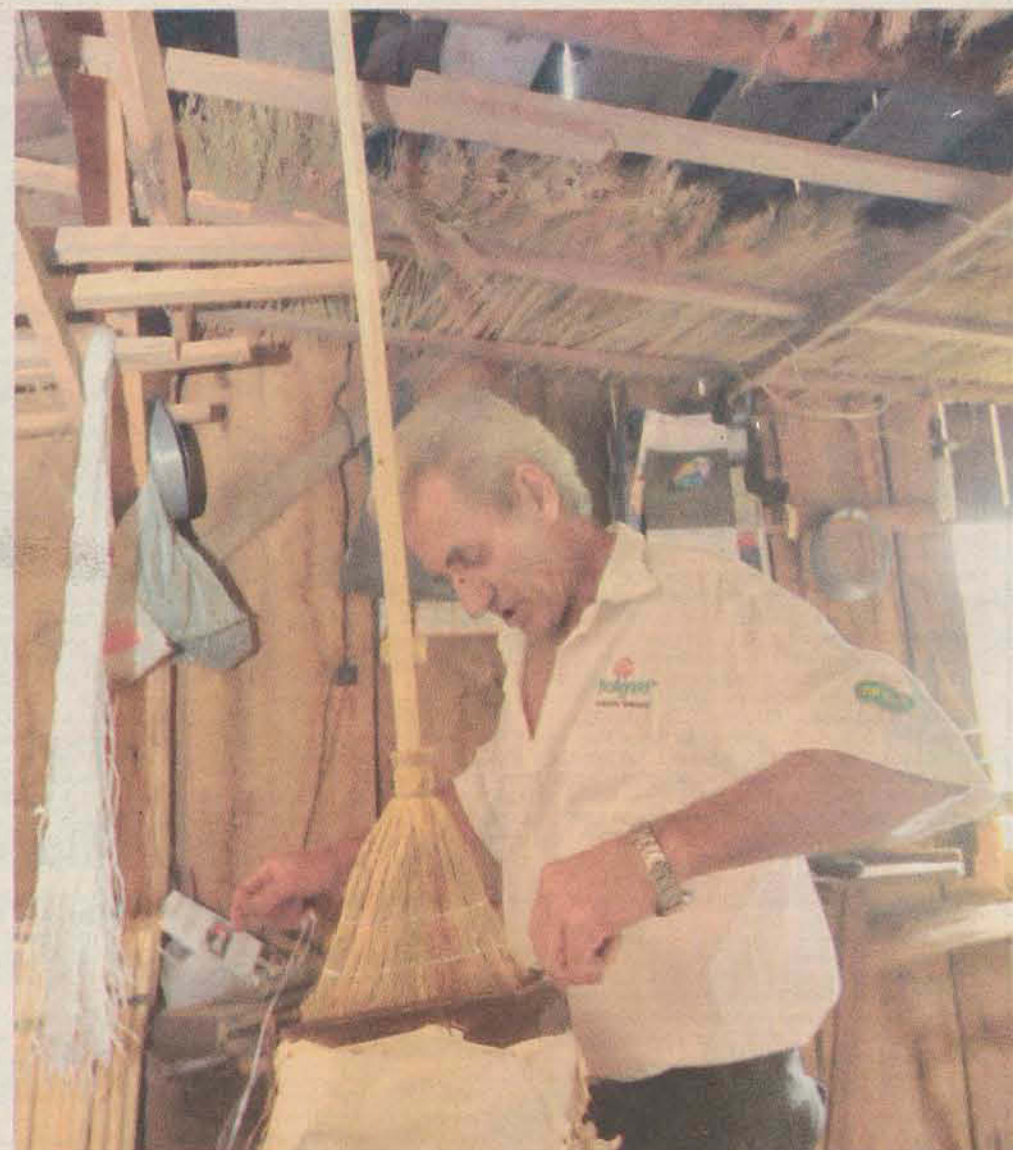
FINAL A vassoura é colocada numa prensa para que as palhas sejam costuradas e fiquem firmes
