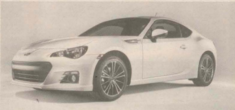
2.0 boxer aspirado de quatro cilindros e injeção direta, capaz de produzir 200 cv e 20,9 kgfm de torque. A tração do modelo é traseira, indo de encontro a tradição da marca.
